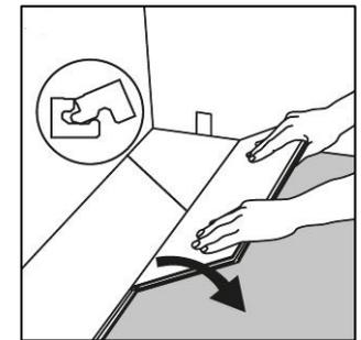
Placez la languette de la première lame de la nouvelle rangée dans la rainure de la lame de la rangée précédente en formant un angle. Poussez vers l'avant et abaissez la lame jusqu'au niveau du sol.
