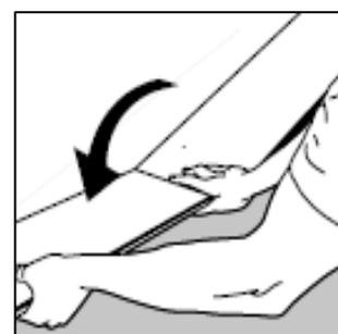
Tracez sur la lame le repère où il faudra scier. Placez la lame face contre sol sur la surface de travail et coupez-la en utilisant une scie.
